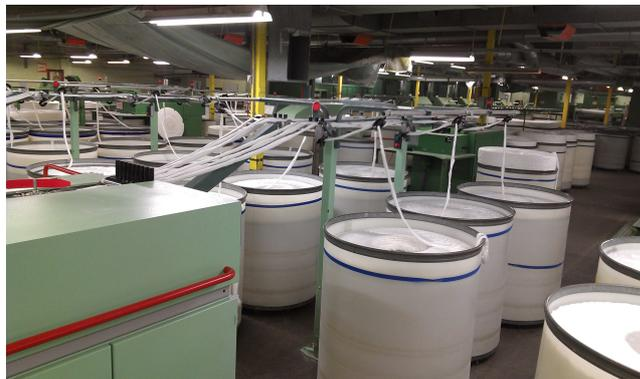
Lorsque le fil à fabriquer est un mélange (polyester coton 50/50 par exemple), le banc d'étirage sera alimenté de 4 rubans de PES et de 4 rubans de coton. Pour obtenir un mélange suffisamment intime entre les 2 fibres, on appliquera alors un 2<sup>ème</sup> passage de banc d'étirage.
