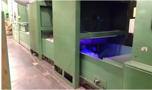
Les chargeuses alimentent pneumatiquement les **ouvreuses**, lesquelles vont démêler les fibres, les désenchevêtrer et commencer à éliminer les matières étrangères (coques de capsules). La matière (alors sous forme de flocons) est encore transportée pneumatiquement dans de gros tuyaux jusqu'aux **cardes**.
