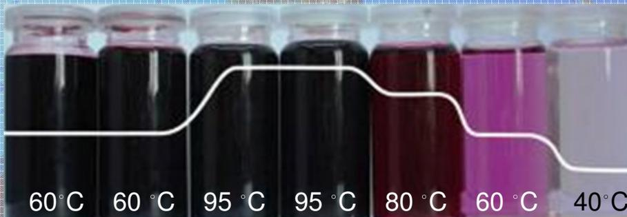
Pour les colorants conventionnels 6-8 bains à haute température seront nécessaires
