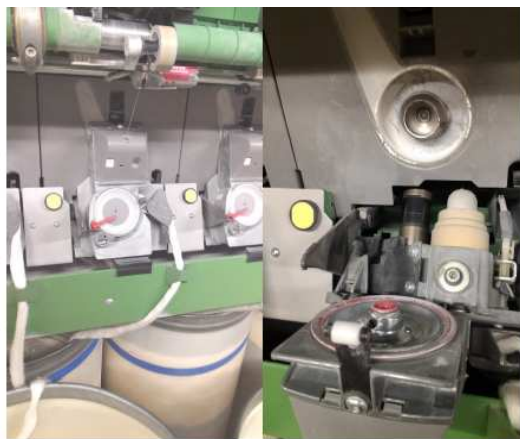
Du ruban au fil, turbine fermée
