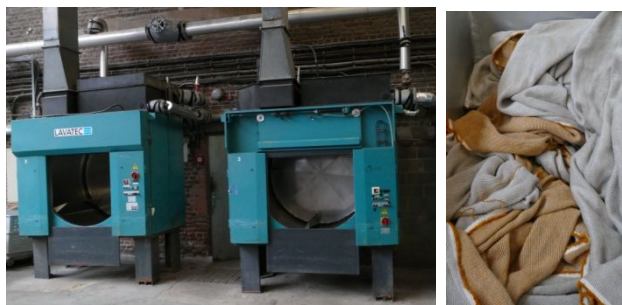
Les tumblers pour « travailler » le toucher (après préséchage sur rame) et garantir la stabilité dimensionnelle
