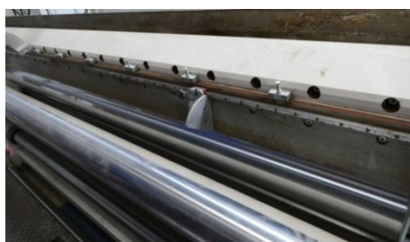
avec racle d'enduction mixte (dans l'air ou sur cylindre) et
